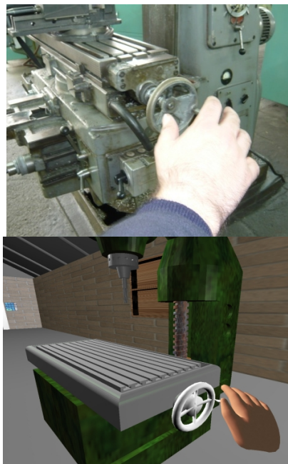
شکل 2- مقایسه محیط مجاز با واقعی - شکل بالا: محیط واقعی و شکل پایین: محیط مجازی معادل آن. در شکل 3 نحوه عملکرد محیط مجازی را در هنگام فرزکاری نشان می دهد.
